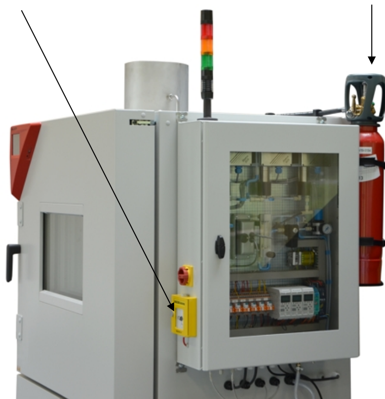
Abbildung 12: Position der Einrichtungen zur CO 2 -Feuerunterdrückungseinrichtung
